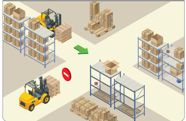
교차로 충돌 경고 시스템 (차량 ↔ 구역)
