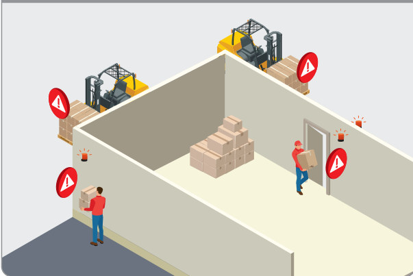
사각지대 충돌 경고 시스템 (차량 → 구역)
